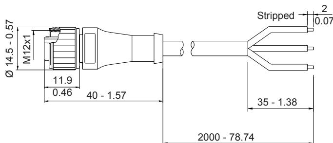
Cable / Cavo / Cable / Kabel / Câble / Кабель M12
