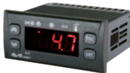
Für eine wirkungsvollere Verwaltung der Kühlanlage sieht ID985/V einen Regler für die Steuerung der Verflüssigerventilatoren vor und bietet daneben die Möglichkeit, mit Hilfe eines dritten Fühlers das Abtauen eines zweiten Verdampfers zu steuern.
