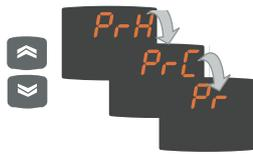
Durch Drücken der Taste 'set' bei Erscheinen des Labels **Pid** wird das Label der ersten Unter-Registerkarte **PrH** angezeigt. Die Unter-Registerkarten können mit den Tasten UP und DOWN durchlaufen werden.
