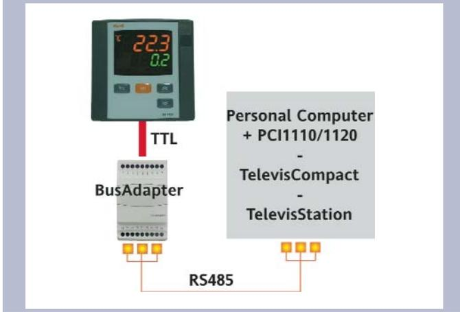
Der Anschluss an die Fernsteuerungssysteme Televis kann über den seriellen Port TTL (unter Verwendung des Schnittstellenmoduls TTL- RS 485 BUS ADAPTER 130 oder 150) oder bei den Modellen, für die es vorgesehen ist (EW7222), über Direktanschluss RS485 erfolgen. Für die entsprechende Konfigurierung des Gerätes muss man die Registerkarte mit dem Label "Add" aufrufen und die Parameter "dEA" und "FAA" verwenden.
