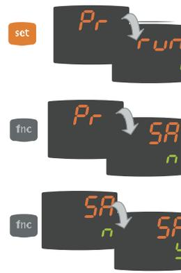
Sobald die gewünschte Unter-Registerkarte erscheint, die Taste 'set' drücken, um auf die Parameter zuzugreifen. Zum Durchlauf der Parameter die Taste 'set', zum Ändern des Wertes die Tasten UP und DOWN betätigen.
