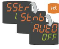
Es werden das Label und der aktuelle Status der Funktion angezeigt. Zum Durchlaufen aller vorhandenen Funktionen die Taste 'set' drücken.
