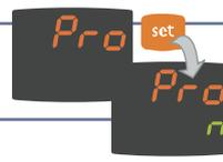
Den Zugang zu jeder Registerkarte erhält man durch Drücken der Taste set bei Erscheinen des gewünschten Labels.
