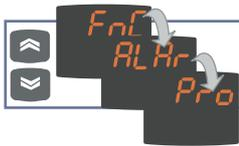
Nach Drücken der Taste 'fnc' können die Registerkarten des Menüs mit den Tasten UP und DOWN durchgegangen werden.
