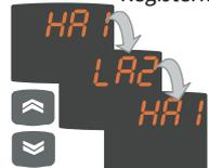
Sind dagegen Alarme vorhanden, können sie mit den Tasten UP und DOWN angezeigt und durchgegangen werden.
