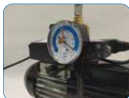
Collegamento con pompa per vuoto
